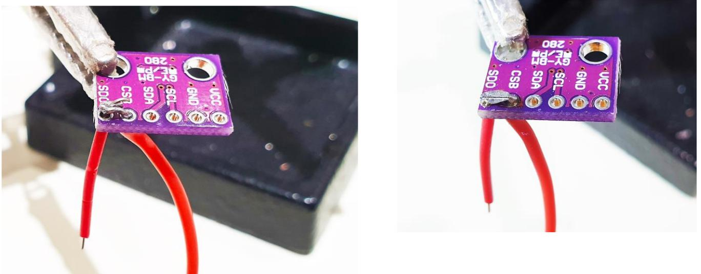
Figure 23 – Jonction des deux fils rouges (le long et le court)
