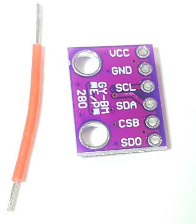
Figure 22 – Le fil rouge « court » et le capteur de température/pression
